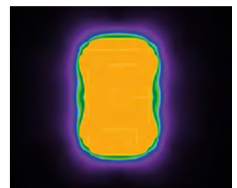
LO: Beleuchtung eines Sportplatzes mit Scheinwerfern mit Streulichtbegrenzung (LO)
