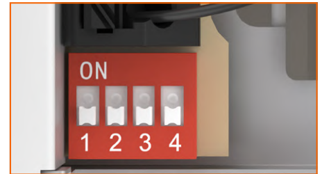
DIP-Schalter zur einfachen Einstellung der Leistungsstufen
